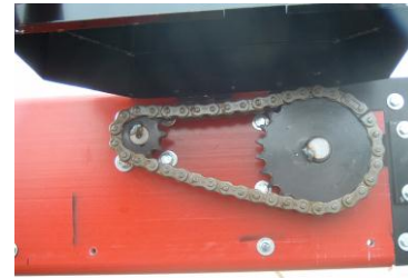
Fig. 4-1 Inspeccione el control de la cadena y ajuste la tensión.
