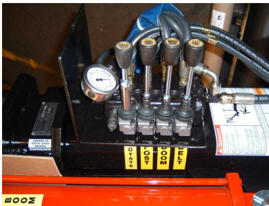
Fig. 3-1 Controles hidráulicos montados en el Poste Central
