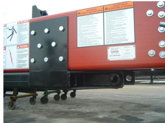
Figura 2-3 Ensamble la porción auxiliar de la banda transportadora en el Poste Central utilizando la clavija de 1 ¼" por 14 ¾"
