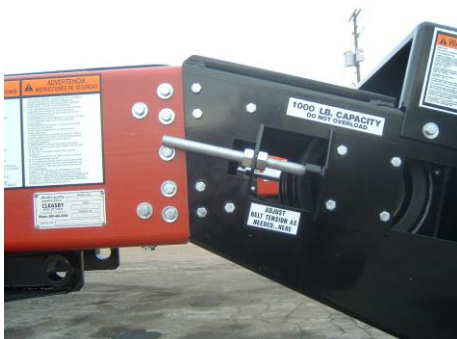
Fig. 4-3 La tensión de la correa de la banda transportadora se ajusta girando los tornillos de la base de la banda transportadora
