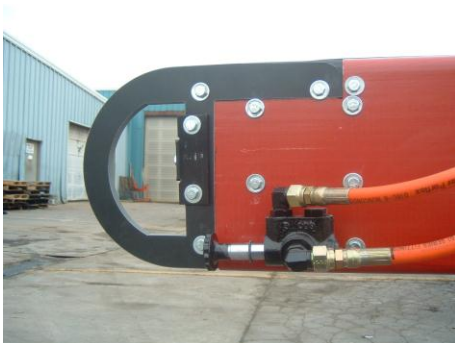
Fig. 3-2 La válvula de Control en la nariz de las bandas transportadoras FBR permite recibir a una persona para controlar el flujo de material.
